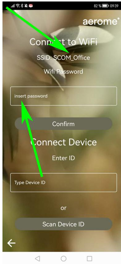
i. Klicken Sie auf den Button „Confirm“ um die Verbindung zwischen dem mobilen Endgerät und dem scene zu initiieren.
