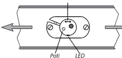
Der Sensorkopf muß mindestens 34 mm (max. 115 mm) in den Kanal hineinragen und im Bereich der größten Strömungsgeschwindigkeit liegen. Vermeiden Sie Turbulenzonen (vor dem Sensor  $5 \times D$ , nach dem Sensor  $3 \times D$  Abstand zu Störelementen).
