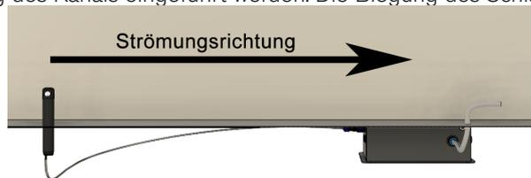
Die Bohrung für den Luftstromwächter beträgt 23mm und sollte  $>1$  m vor der Bohrung für den Luftschlauch liegen. Der Luftstromwächter wird mittels der Montageschelle festgeklemmt. Zwischen Kanal und Montageschelle legt man die mitgelieferte Moosgummidichtung zum luftdichten Abschluß.
