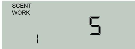
Nach erneutem Drücken der Taste "MODE" befinden Sie sich in der Einstellung der Pause. Diese muss mindestens 90 Sekunden lang sein und wird mit den Pfeiltasten in vordefinierten Schritten eingestellt.
