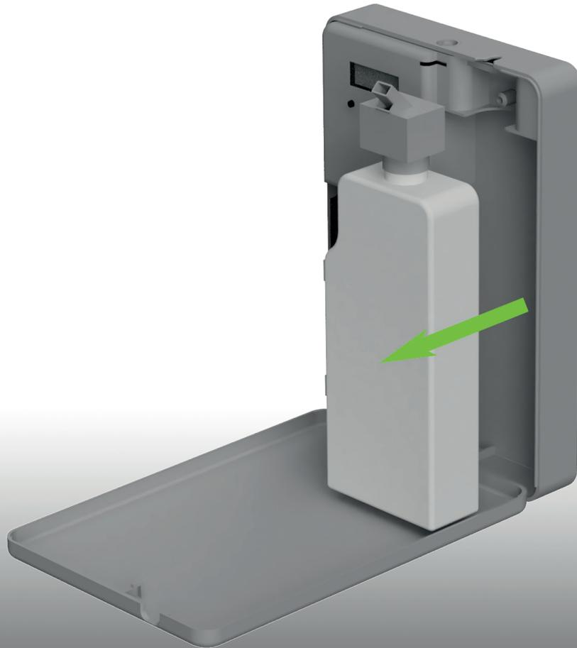
Drehen Sie den Verneblerkopf entgegen des Uhrzeigersinns, um ihn zu lösen und ziehen Sie ihn langsam nach oben aus der Kartusche heraus. Beachten Sie, dass die Unterseite des Verneblerkopfs und der Schlauch mit Duftöl benetzt sein können.
