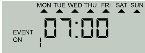
"EVENT ON" bedeutet, dass das Gerät zu dieser Zeit eingeschaltet wird. Die "1" bedeutet, dass es sich um den ersten von 5 möglichen Speicherplätzen handelt. Die Dreiecke unter den Kürzeln für die Wochentage bedeuten, dass das Gerät jeden Tag um 07:00 Uhr einschaltet.
